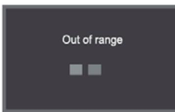
El monitor se mostrará fuera de rango si el monitor excede la resolución máxima.
