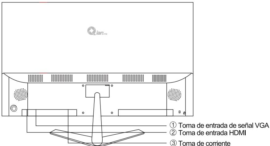
**1. 1 Puerto VGA:** Conecta la toma de salida de señal VGA.
