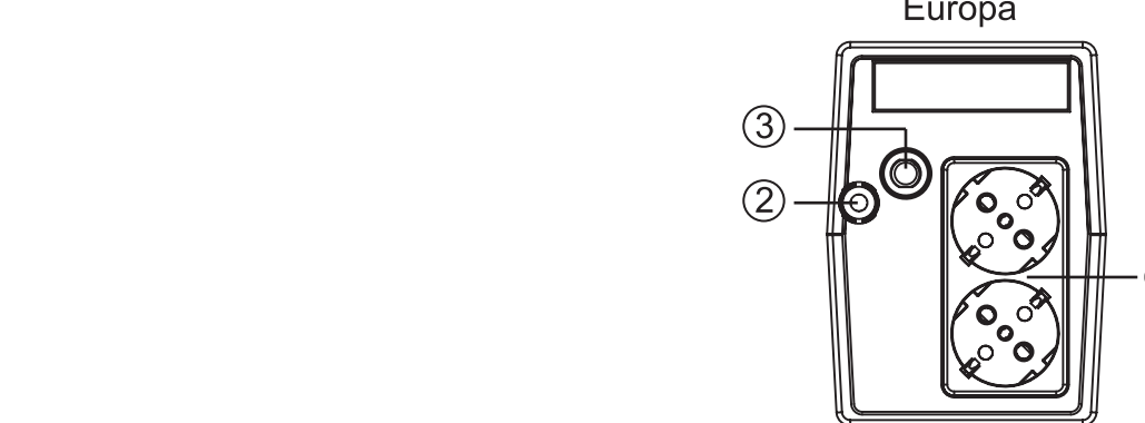
1.- Interruptor, 2.- Entrada AC, 3.- Fusible de entrada AC
